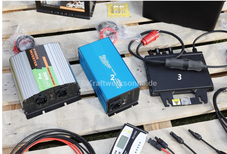
Foto v.l.n.r.: Beispiele Wechselrichter (1. WR modifiziert; 2. WR echte Sinuswelle; 3. WR öffentliches Netz)
